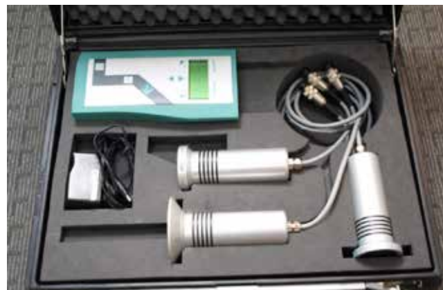
Messgerät inklusive Messköpfe für die zerstörungsarme Rastermessung.
