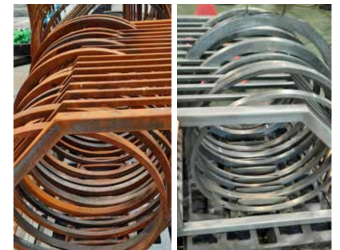
Vorher-nachher-Vergleich: Werkzeuge vor und nach der Tauchbadsanierung.
