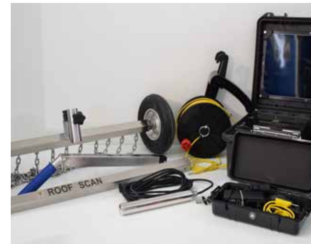
Zerstörungsfreie Methode zur schnellen Erkennung von Dachlecks.
