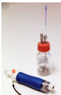
Figur 3: Pump för Kitagawa rör och provbehållare.
