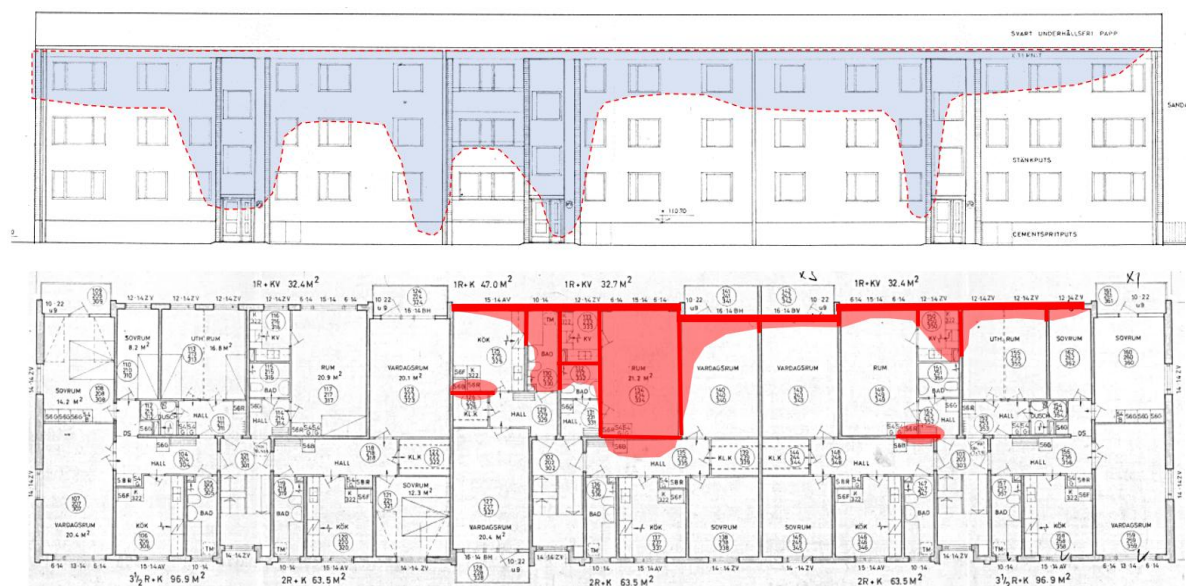
Figur 15: Exempel på övergripande markering av skadeutbredning ytterväggar och våningsplan (färgade områden indikerar vattenskada).
