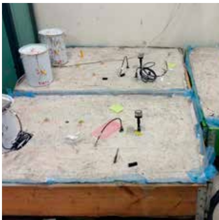
FIGUR 5 Polygon och AK-konsult håller just nu på med ett stort kvalitetssäkringsprojekt gällande montage teknik och mätteknik i fält. Här syns delar av mätuppställningen i laboratoriemiljö där ett antal mättekniker och montage tekniker korstestas mot varandra i syfte att upptäcka systematiska skillnader.
