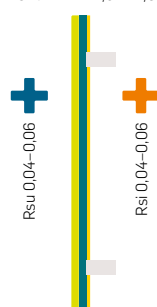
Bild 6. Samma princip gäller vid oisolerade ytterväggar. Det går inte att torka en utfackningsvägg effektivt om den yttre isoleringen inte monterats.
