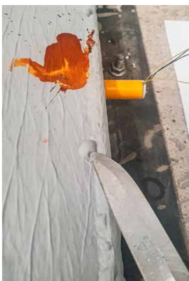
Figur 18. Kondensbubblor tätskitt (rostfärgad på grund av stålram).
