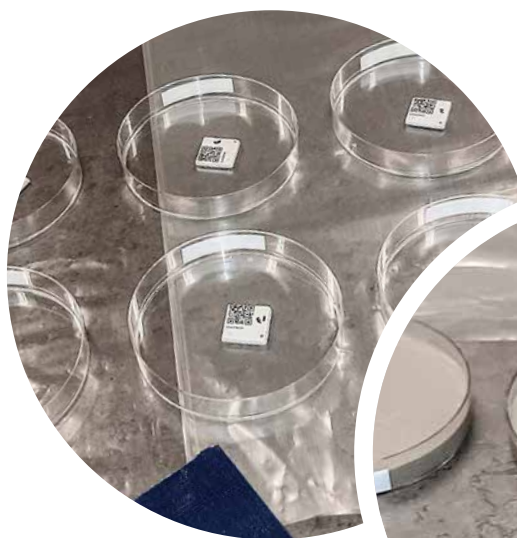
Figur 10. Uppställning petriskålar och fuktsensorer.
